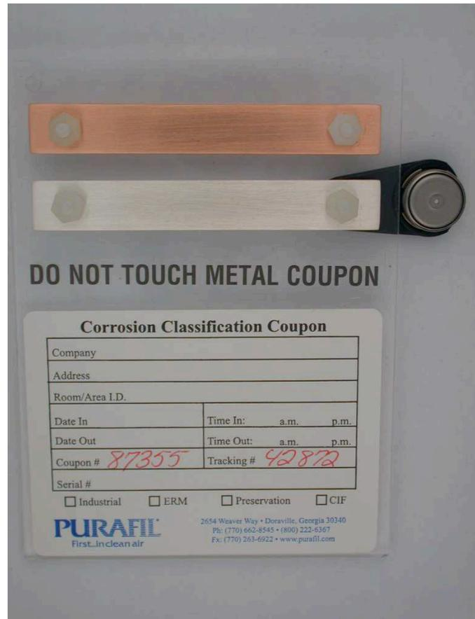
Abb. 1 (Korrosions-Coupon CCC Plus)
